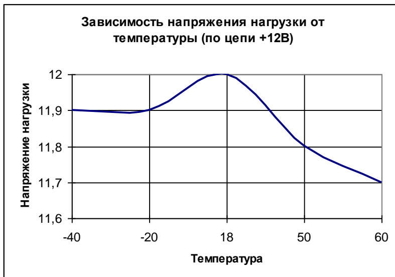
Рисунок В.3 - зависимость напряжения нагрузки по цепи +12В
