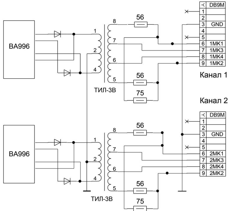
**Рис. 8. Подключение устройства к линии передачи информации.**
