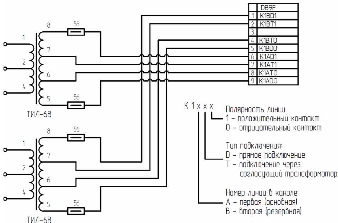
Рисунок 4. Подключение TA1-USB-01 к линиям передачи информации.
