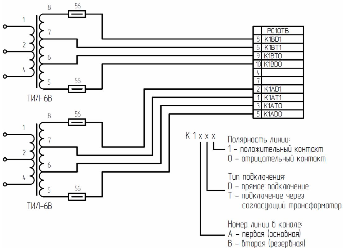
**Рисунок 5. Подключение TA1-USB-02 к линиям передачи информации.**
