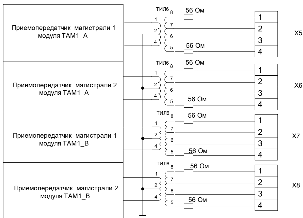
Рисунок 10 - Схема подключения изделия к магистрали ГОСТ Р 52070
