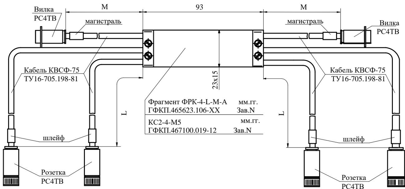
Габаритный чертеж фрагментов кабелей ФРК-4-L-M-A
