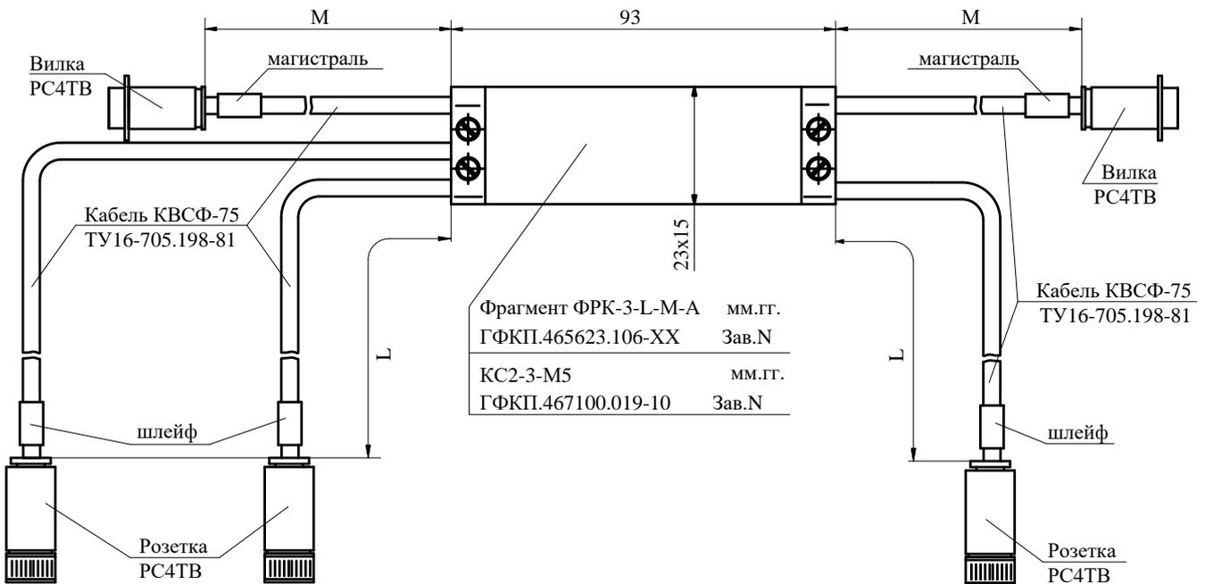
Габаритный чертеж фрагментов кабелей ФРК-3-L-M-A
