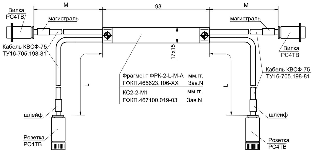
Габаритный чертеж фрагментов кабелей ФРК-2-L-M-A
