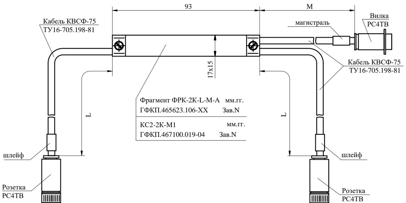
Габаритный чертеж фрагментов кабелей ФРК-2K-L-M-A
