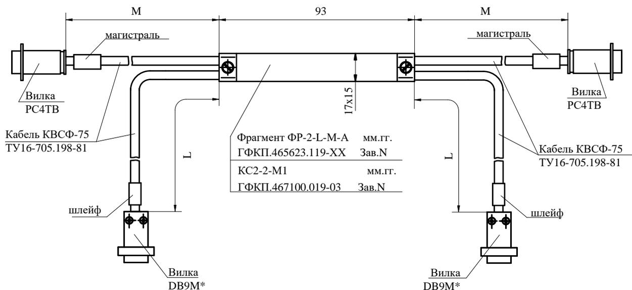
DB9M\* - технологический разъем, демонтируемый при конечном монтаже
