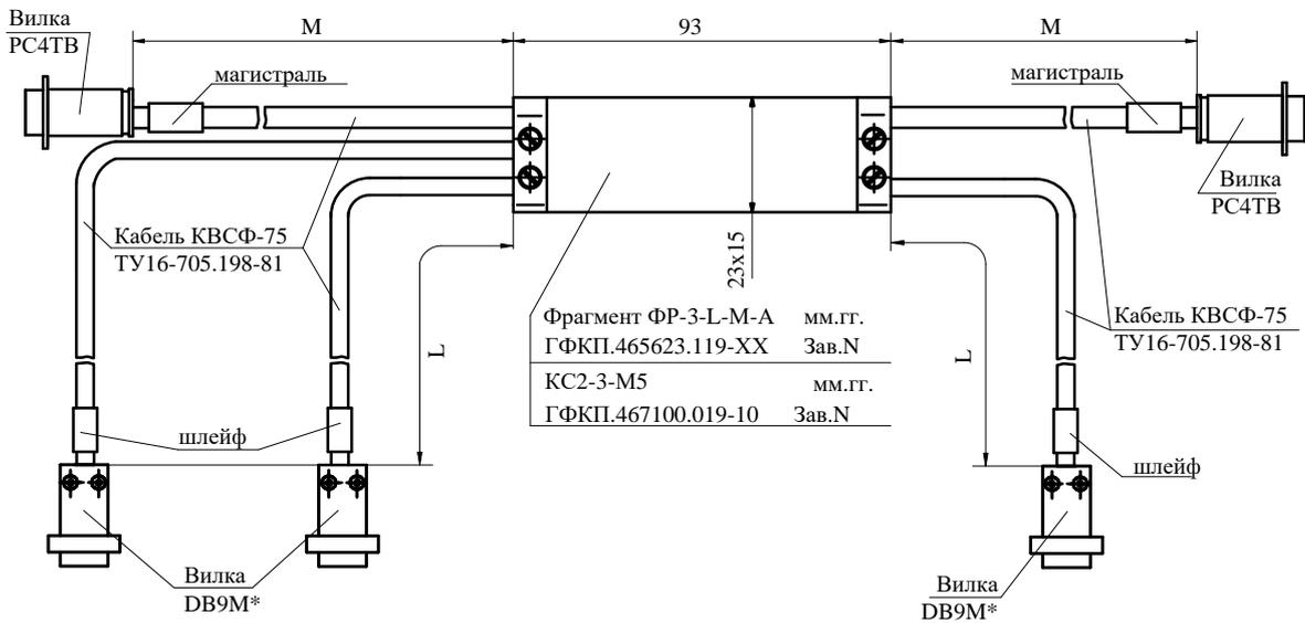
DV9M\* - технологический разъем, демонтируемый при конечном монтаже
