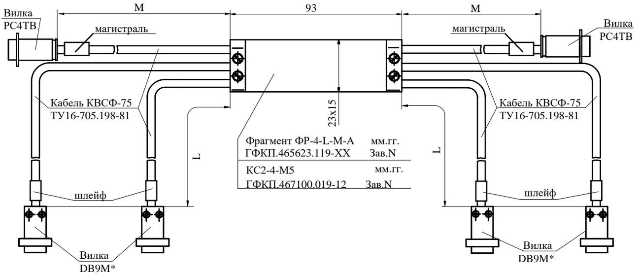
DB9M\* - технологический разъем, демонтируемый при конечном монтаже
