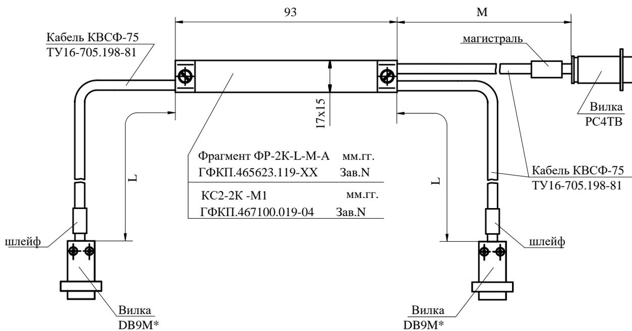
DB9M\* - технологический разъем, демонтируемый при конечном монтаже
