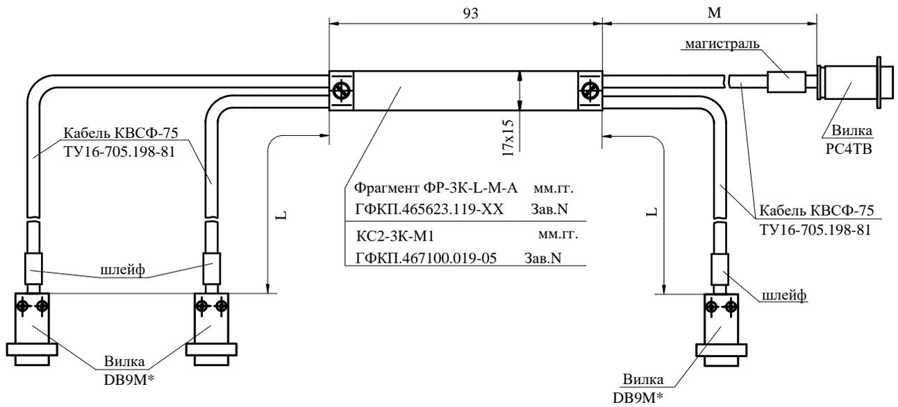
DV9M\* - технологический разъем, демонтируемый при конечном монтаже
