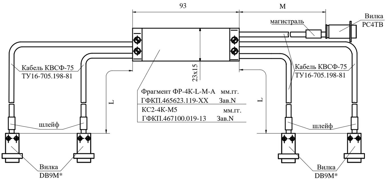
DB9M\* - технологический разъем, демонтируемый при конечном монтаже
