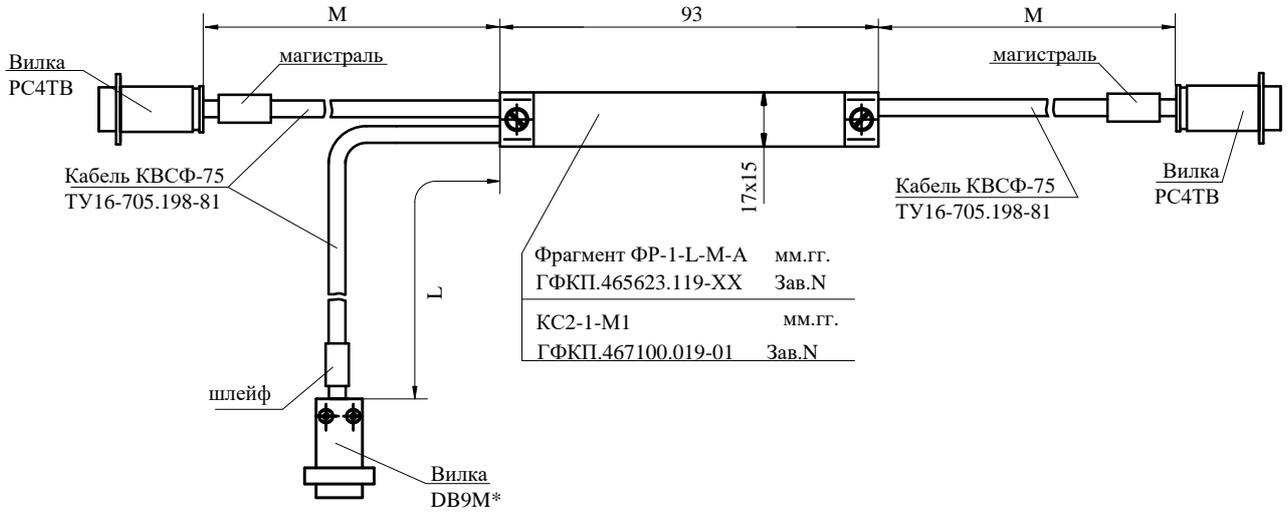
DV9M\* - технологический разъем, демонтируемый при конечном монтаже
