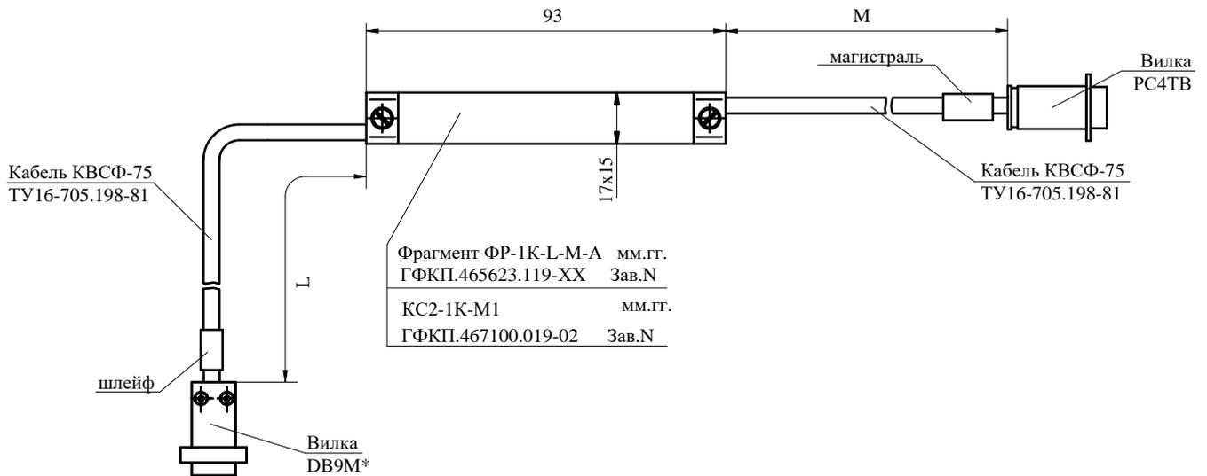
DV9M\* - технологический разъем, демонтируемый при конечном монтаже
