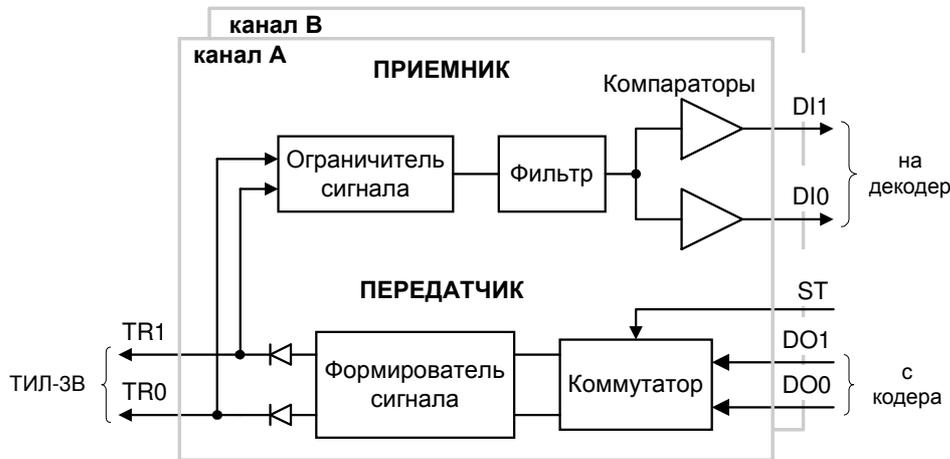
Приемопередатчик EL-15R содержит сдвоенную пару передатчик – приемник и полностью соответствует спецификациям ГОСТ Р 52070-2003 (MIL-STD-1553B).
