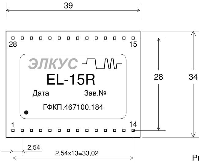
Рис.4 Установочные размеры EL-15R.
