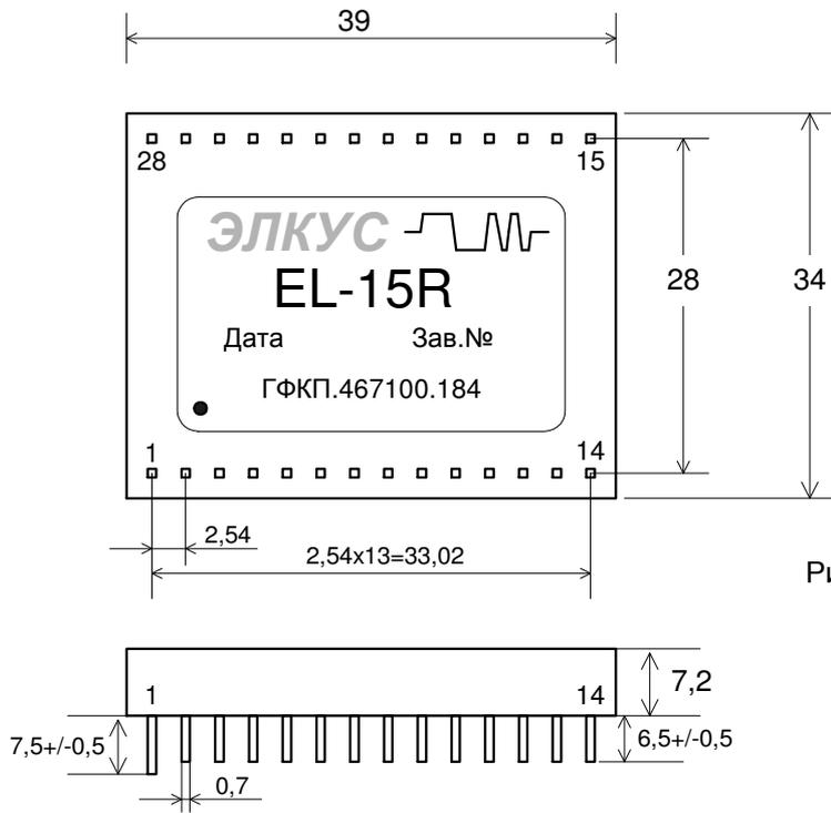
Рис.4 Установочные размеры EL-15R.
