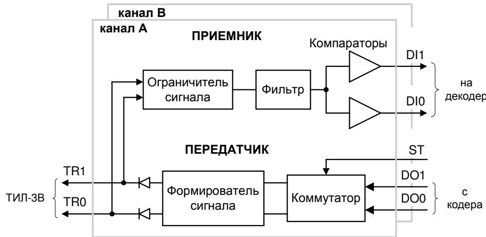
Приемопередатчик EL-15R содержит сдвоенную пару передатчик – приемник и полностью соответствует спецификациям ГОСТ Р 52070-2003 (MIL-STD-1553В).
