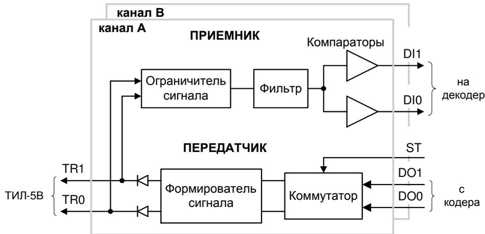
Приемопередатчик EL-12R содержит двояную пару передатчик – приемник и полностью соответствует спецификациям ГОСТ Р 52070-2003 (MIL-STD-1553B).
