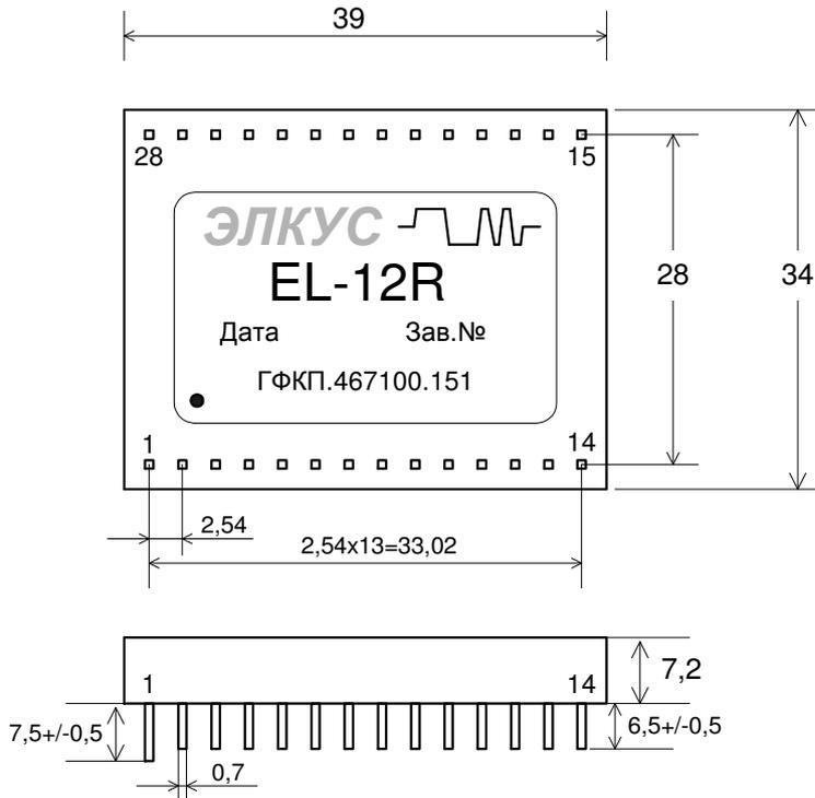
Рис.4 Установочные размеры EL-12R.
